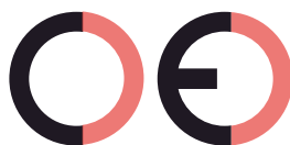
Marcatura CE contraffatta (troppo distante)
