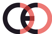
Marcatura CE contraffatta (troppo vicino)
